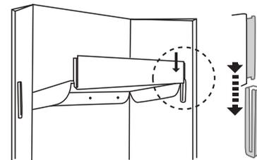
2. Doble las pestañas de la CHAROLA e inserte los clips deslizándolos hacia abajo para que queden abrochados de ambos lados. Coloque la CHAROLA FALDÓN en el nivel inferior.
